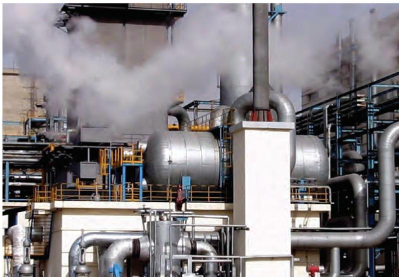
**Figura 51.6** Uno dei reattori ad alta pressione utilizzati per la sintesi catalitica dell'ammoniaca. Il reattore deve essere in grado di sopportare pressioni interne maggiori di 250 atm. [ZD GONG/EPA/Newscom.]
