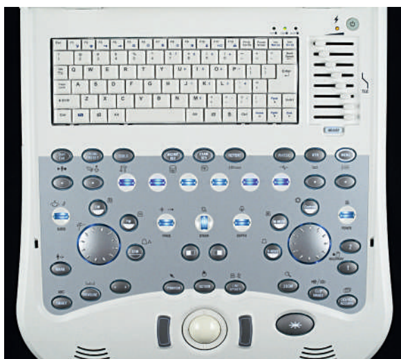
Fig. 1.7 Comandi a disposizione dell'operatore. L'ecografista deve far pratica con i comandi per far sì che l'ottimizzazione dell'immagine diventi un'abitudine. Ogni pulsante è contraddistinto da lettere o simboli che ne identificano facilmente la funzione. Nella parte superiore dell'immagine è riportata una tastiera alfanumerica. Sulla destra si trovano i comandi della compensazione del guadagno di tempo (Time-Gain Compensation, TGC). La rotella grande sulla destra è il regolatore del guadagno per la modalità brightness (B)- e motion (M)-mode, e il pulsante Power è visibile in alto a destra. I comandi per il Doppler sono disposti intorno alla rotella guadagno, sulla sinistra, e nella fila inferiore di interruttori blu. Nonostante la presenza di molti interruttori e manopole, l'abitudine all'uso del computer dovrebbe permettere alla maggior parte degli operatori di apprendere facilmente l'uso dei comandi in un tempo relativamente veloce. (MyLab 30, Biosound Esaote, Indianapolis, IN)
