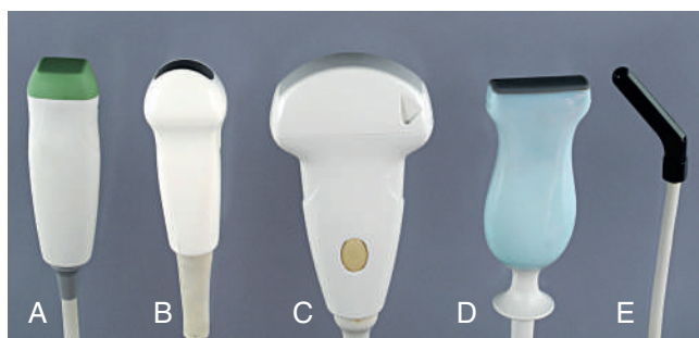
Fig. 1.22 Trasduttori utilizzati comunemente nell'ecografia diagnostica dei piccoli animali. A , Phased array . B , Microconvex . C , Convex . D , Lineare . E , Lineare endocavitaria o intraoperatoria .
