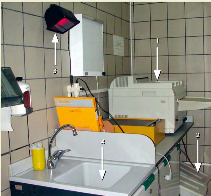
**FIGURA 1.24** Camera oscura per lo sviluppo delle pellicole radiografiche: 1: sviluppatore automatico; 2: vassoi per la raccolta delle soluzioni di sviluppo; 3 lampadina a luce rossa che può rimanere accesa durante le operazioni di sviluppo; 4: lavandino.
