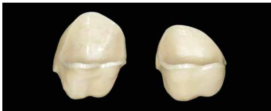
Figura 1.1 ● Cappette in zirconia per corone in ceramica su zirconia con preparazioni a finire (2008). La zona marginale è modellata in analogia a quanto tradizionalmente fatto con il metallo in queste stesse situazioni.
